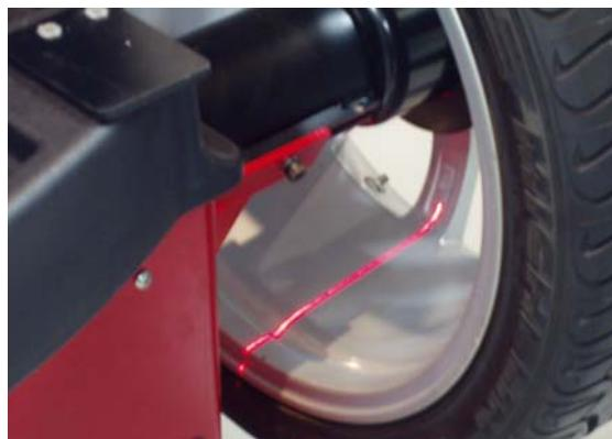
Альтернативный метод расположения приклеиваемого груза заключается в использовании внутреннего измерительного рычага и сервопривода.
