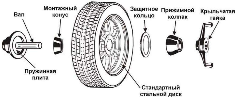
**ПРИМЕЧАНИЕ:** Используйте только крыльчатую гайку поставляемую с GSP9600HD.
