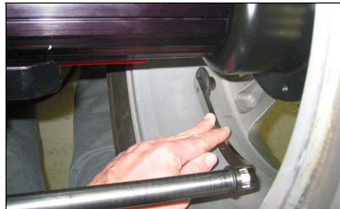
Возможно сканирование диска с кромки обода или изнутри обода. Расположите внутренний измерительный рычаг на внутренней части обода и **нажмите и удерживайте** педаль.
