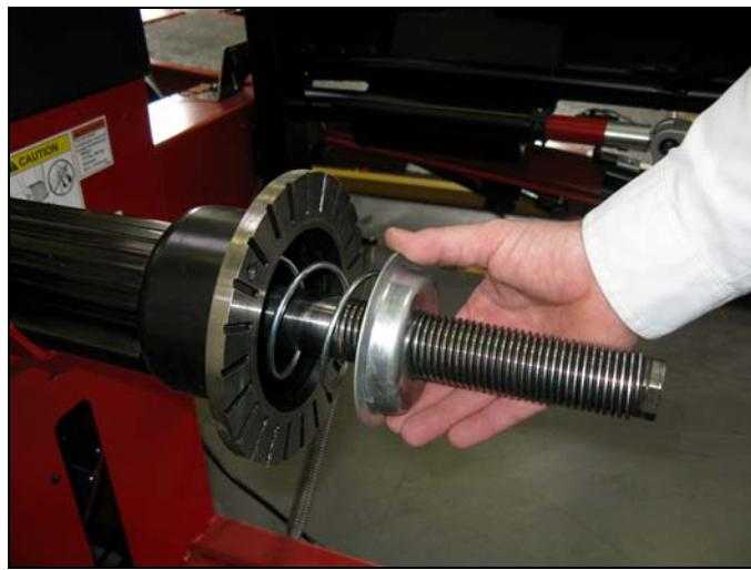
С открытым кожухом насадите конус на вал до контакта с тарелкой пружины. Установите колесо внутренней стороной к балансировочному станку и отцентруйте колесо на конусе.
