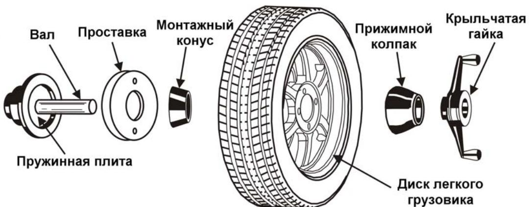
**ПРИМЕЧАНИЕ:** Эта модель станка оборудована съемной нагрузочной пружиной. Съемная нагрузочная пружина не используется с большегрузными адаптерами. Она используется только с монтажными адаптерами для пассажирских автомобилей и пикапов.
