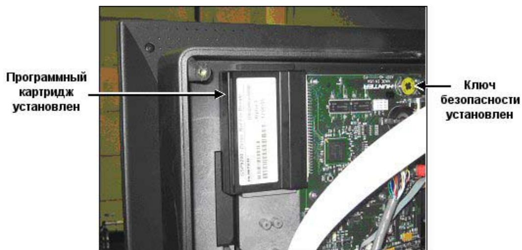
Вставьте электронный ключ безопасности в нижнее гнездо на плате узла суппорта.
