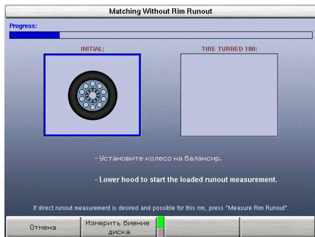
Станок провернет колесо на 180 градусов.
