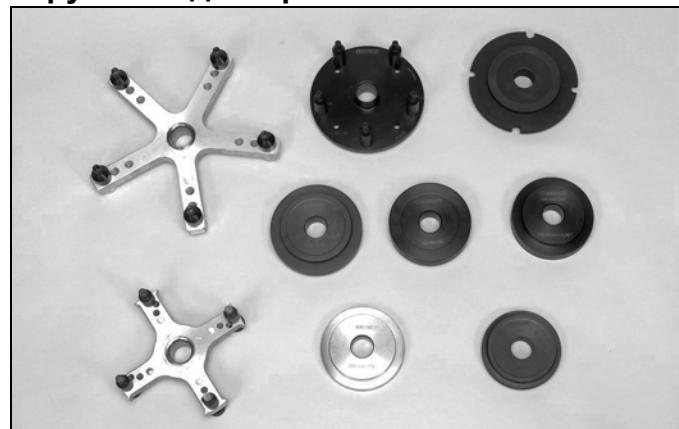
При использовании среднегрузных адаптеров, колета устанавливается на шпиндель ступенчатой стороной в сторону колеса.
