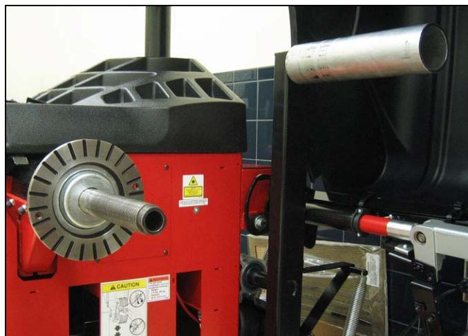
Отсоедините подачу воздуха и пружину возврата нагрузочного роллера.
