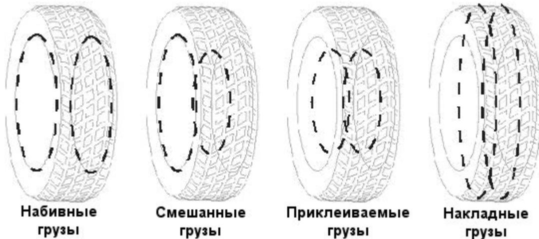
В режиме "СТАНДАРТНАЯ БАЛАНСИРОВКА" с использованием только прикрепляемых грузов, левая и правая плоскости задаются следующим образом:
