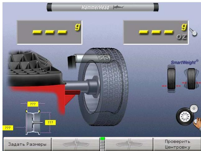
Если SmartWeight потребует коррекционных грузов – должны быть введены размеры колеса. Введите размеры используя измерительные рычаги. Графика колеса SmartWeight выведет допустимую силу дисбаланса в зеленом свете, чрезмерную – в красном. До снятия измерений графика колеса остается бесцветной.
