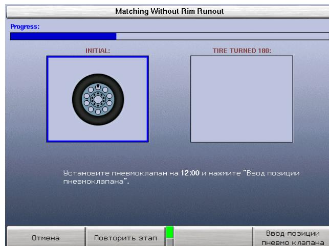
Снимите колесо с вала и совместите пометку нашине с пневмоклапаном.
