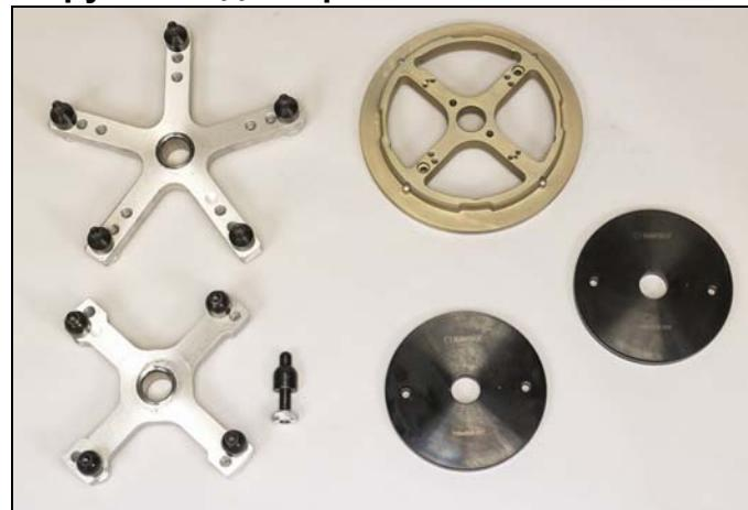
При использовании большегрузных адаптеров проставка (золотая) и колета (черная) могут быть зафиксированы на шпинделе.
