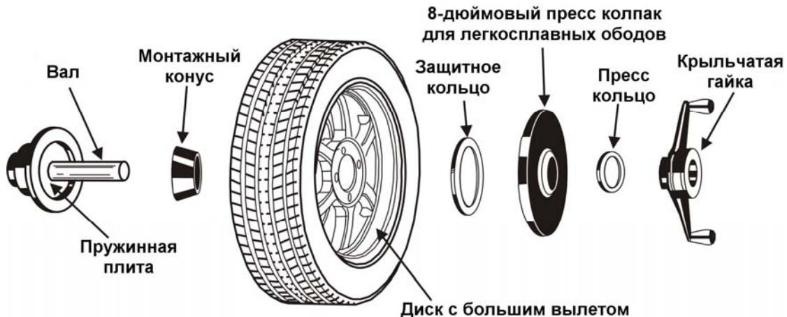
**ПРИМЕЧАНИЕ:** Эта модель станка оборудована съемной нагрузочной пружиной. Съемная нагрузочная пружина не используется с большегрузными адаптерами. Она используется только с монтажными адаптерами для пассажирских автомобилей и пикапов.
