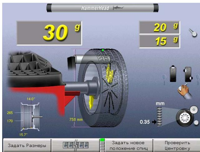
Разместите груз левой плоскости (при **ДИНАМИЧЕСКОМ** режиме) в соответствии с выполняемой балансировочной процедурой. Смотрите раздел «Процедуры Балансировки».
