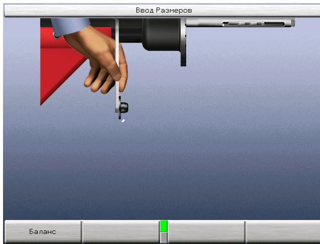
Как показано ниже перемещайте внутренний измерительный рычаг по внутренней поверхности диска и на экране появится его отображение. При относительно неторопливом премещении внутреннего измерительного рычага по внутренней поверхности диска – отображение будет более аккуратным особенно для дисков сложной внутренней конфигурации.
