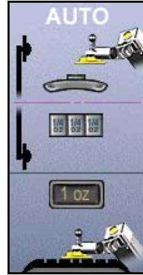
Данный выбор автоматически определяет должный тип груза и место его расположения согласно расположению измерительных рычагов.
