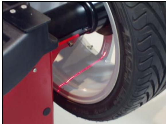
Альтернативный метод расположения клеящегося груза заключается в использовании внутреннего измерительного рычага и сервопривода.
