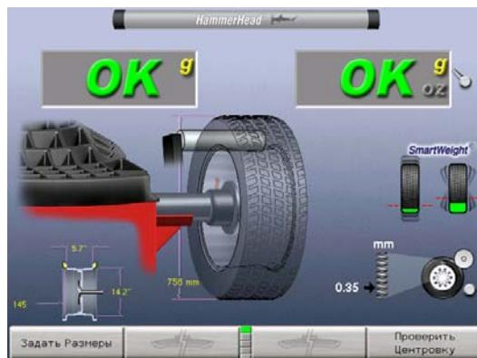
TranzSaver™ выводит диаметр колеса на экран баланса. Измерение нагруженного диаметра шины в сравнении с другими шинами на автомобиле, может быть очень важным для полноприводных автомобилей для нормальной работы карданной передачи и минимизации преждевременной поломки трансмиссии.
